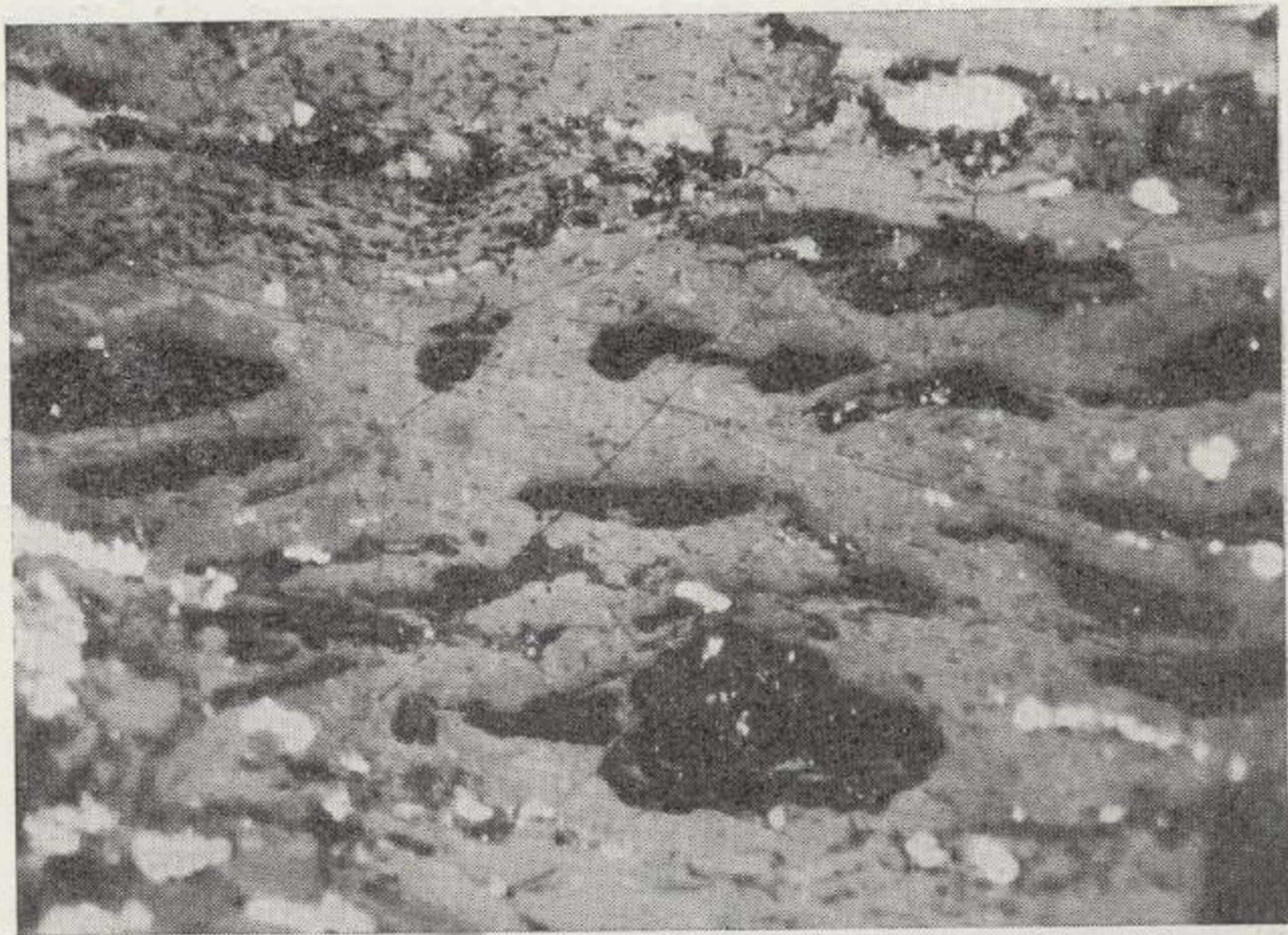
Fotomicrografía 4, sección pulida. L.N. \times 300 . Inmersión en aceite. Lignitos de Calaf, paquete Valentina. Representan un campo con abundancia de crasiesporas (negro) en masa de huminita. Placas dispersas y agregados de pirita singenética (blanco).
